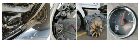
Figura N°74: Cambio del retén del cigüeñal, cambio de boys de combustible
