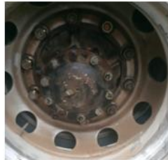
Figura N°56: Cambio de espárragos
