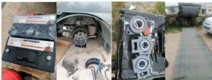
Figura N°52: Cambio de baterías, cambio de zapatas, cambio de chumaceas y cambio de banda transportadora
