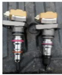
Figura N°24: Cambio de inyector
