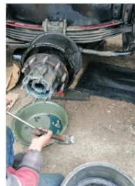
Figura N°73: Cambio de retén y rodillos posteriores
