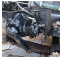
Figura N°27: Reparación caja de dirección
