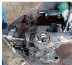
Figura N°17: Reparación caja de dirección
