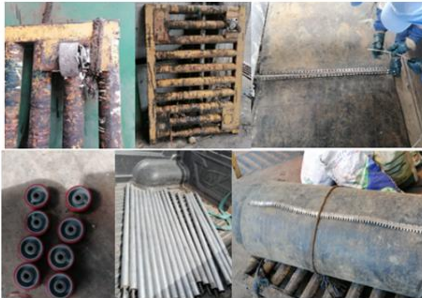
Figura N°76: Mantenimiento de la planta de inorgánico (bandas, rodillos, ruedas de coches, remachado de banda)
