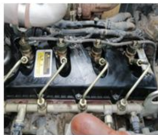
Figura N°47: Corrección de fuga de combustible
