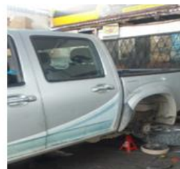
Figura N°14: MTTTO sistema de frenos
