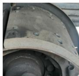
Figura N°39: Recolector UMA-1052 Figura N°40: kit de embrague del ventilador Figura N°41: Remachado de zapatas
