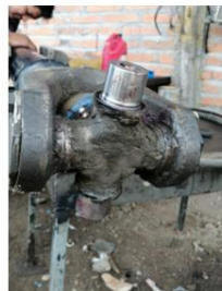
Figura N°72: Cambio de crucetas
