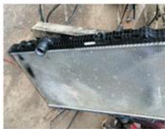
Figura N°43: Cambio tapa superior del radiador Figura N°44: cambio de banda
