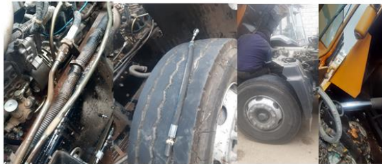
Figura N°51: Cambio de cañería de aceite hidráulico.
