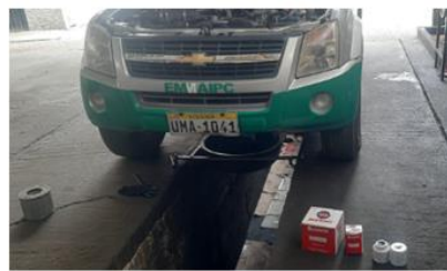
Figura Nº7: MTO preventivo cambio de aceite de motor y filtros
