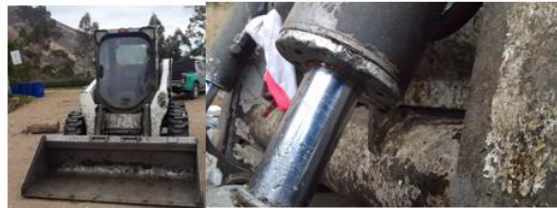
Figura N°68: Fuga de aceite hidráulico por sello del vástago del cilindro hidráulico.
