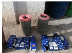
Figura N°45: Cambio de filtros de aire, aceite y combustible
